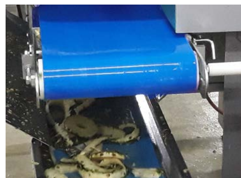
NOVAK S09UF y NOVAK 20CK en transporte de desecho de piña.
