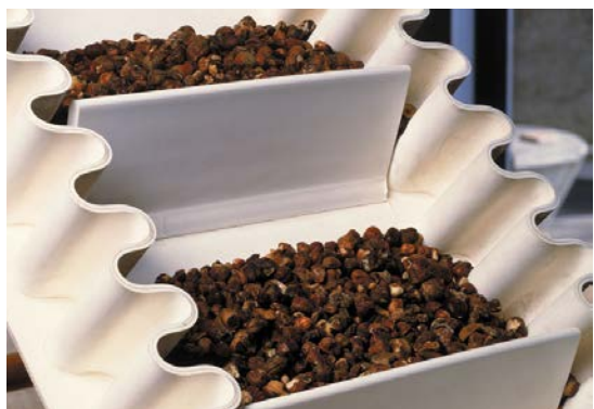
Banda CLINA con Runer y perfiles transversales en transporte inclinado de avellanas.
