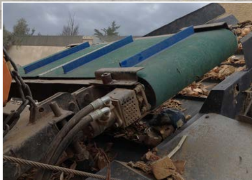
Overband con Keram 40UF + perfil reforz. de PU. Separación residuos metálicos de la madera.
